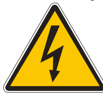
Vigyázz! Áramütés veszélye!
