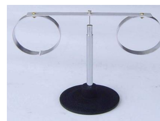
16. ábra: tűcsapágyon forgó abroncspár
