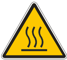
Vigyázz! Meleg felület!
