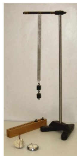
5. ábra: A rezgésidő mérése
