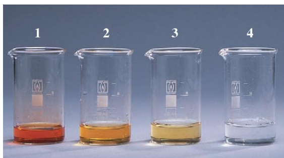
3. ábra: a hangyasav elszínteleníti a brómos vizet 68
