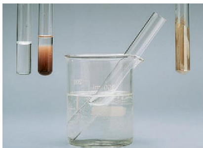
2. ábra: a hangyasav ezüstitűkőr reakciója 67
