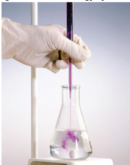
12. ábra Titrálás permanganát mérőoldattal
