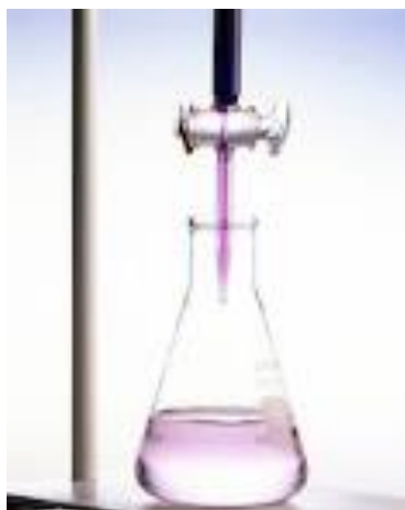
13. ábra A titrálás végpontját a halvány rózsaszín szín jelzi
