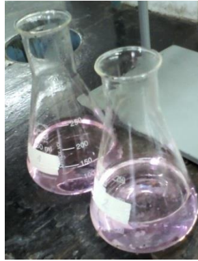
23. ábra A titrálás végpontját a permanganát mérőoldat színe jelzi
