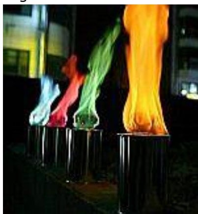
24. ábra Különböző fémvegyületek lángfestése
