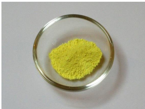
25. ábra A szintézis végén egy sárga színű, szúrós szagú port kapunk. Ez a jodoform
