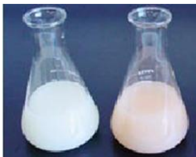
12. ábra A titrálás megkezdésekor és a titrálás végén tapasztalható színváltozás
