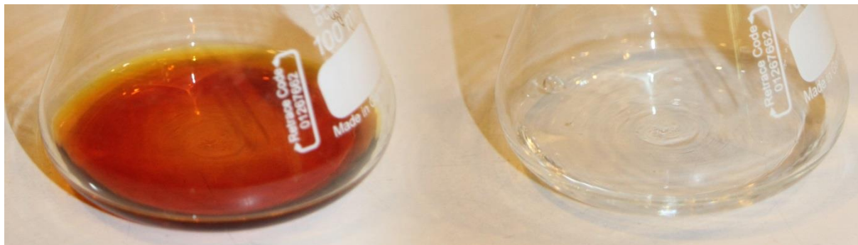
6. ábra A \text{Cu}^{2+} ionok hatására kivált \text{I}_2 titrálása tioszulfáttal
