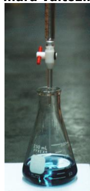
21. ábra \text{Mg}^{2+} ion titrálása EDTE mérőoldattal. Az eriokrómfekete-T indikátor színe a végpontban kékre változik
