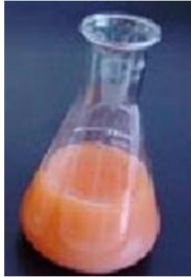
13. ábra A titrálási végpontban a lombik tartalma rozsdabarna színű
