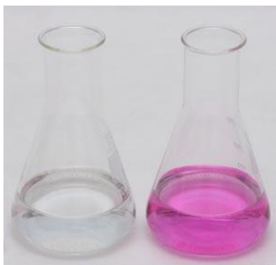
1. ábra A fenolftalein indikátor halvány rózsaszínnel jelzi a titrálási végpontot
