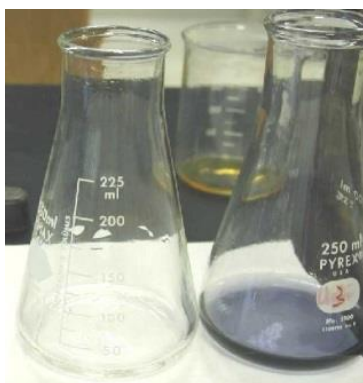
3. ábra A keményítőindikátor a kék szín eltűnésével jelzi a titrálási végpontot
