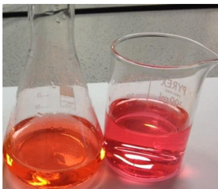
2. ábra A metilvörös indikátor átmeneti hagymahéjszínű (bal oldali) jelzi a titrálási végpontot
