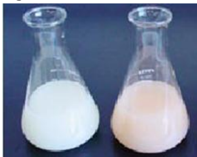
12. ábra A titrálás megkezdésekor és a titrálás végén tapasztalható színváltozás
