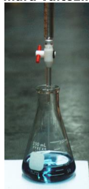
21. ábra Mg 2+ ion titrálása EDTE mérőoldattal. Az eriokrómfekete-T indikátor színe a végpontban kékre változik
